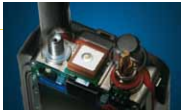
Lage des GPS-Empfängers im Inneren des Gehäuses
