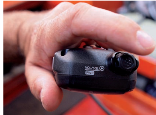
Kombinierter Einschalt-, Lautstärke und Squelch-Regler an der Oberseite. Durch Drücken erfolgt die Umschaltung der Funktionen.
