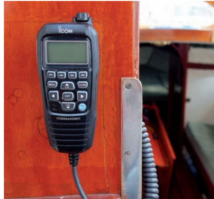
Flexibel und wasserdicht: Mit der beiliegenden Halterung kann das Commandmic direkt draußen im Cockpit oder am Schott eingehängt werden.
