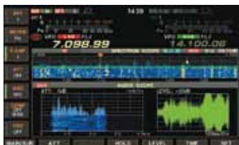
Mini-Wasserfall (Mitte) sowie FFT-Spektrum mit Wasserfall (links unten) und Oszilloskop (r. u.)
