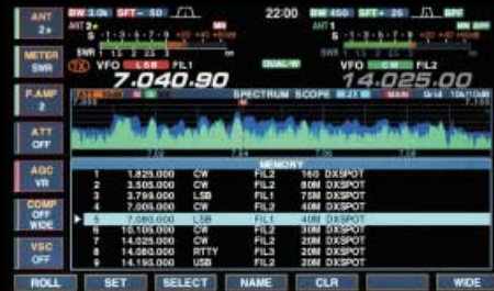
Display mit eingebledetem Minispektrumskop
