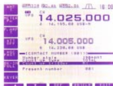
[Bild 10] QSO-Nummer Sehr praktisch im Contest-Betrieb. Die QSOs werden laufend numeriert. Das Numerierungsformat ist wählbar.
