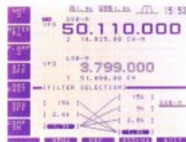
[Bild 6] Filterkombinationen In diesem Beispiel werden die Filtereinstellungen für SSB-Schmal gewählt.
