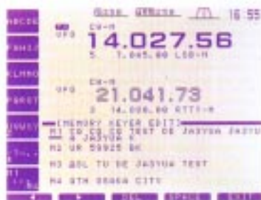
[Bild 5] Memory-Keyer-1 Keyer-Speicher "M3" wird editiert. Die Funktionstasten links und unterhalb des LCDs sowie die Tastatur können dafür verwendet werden.
