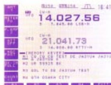
[Bild 9] Memory-Keyer-2 In diesem Beispiel werden die zum Aussenden über den Memory-Keyer gespeicherten Daten gezeigt. Durch Betätigen der Tasten M1-M4 werden die gespeicherten Daten gesendet.
