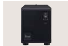
PS-126 NETZTEIL Netzteil mit 4-poligem Kabel. Ausgangsspannung: 13,8 V DC (max. 25 A)
