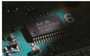
AD/DA-Wandler AK4620B ADC-Signal/(Noise+Distortion): 100 dB ADC-Dynamikbereich, S/N: 113 dB DAC-Signal/(Noise+Distortion): 97 dB DAC-Dynamikbereich, S/N: 115 dB
